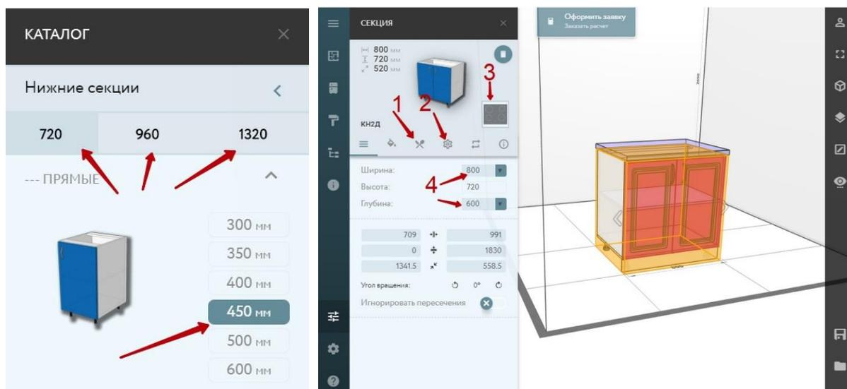
Кроме рассмотренных выше функций работы с 3D объектом (изменение размеров (4), положение в пространстве, выбор декора, замена, вращение и удаление), у нижнего модуля добавляются новые вкладки «Комплектующие» (1), «Настройки» (2) и добавление варочной панели или мойки (3).
